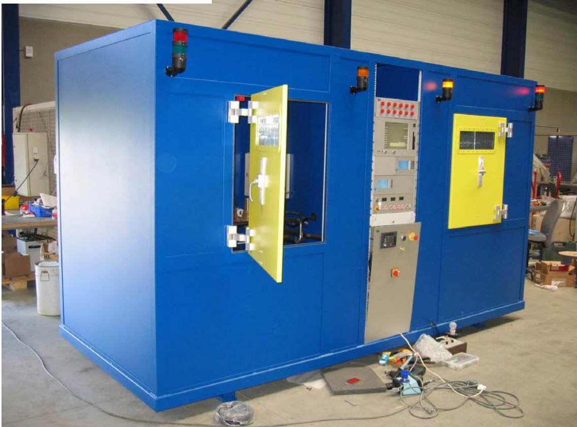
Cage avec deux zones de test – 8 x 2,5 x 2,5m – l'opérateur reste à l'extérieur de la cage
