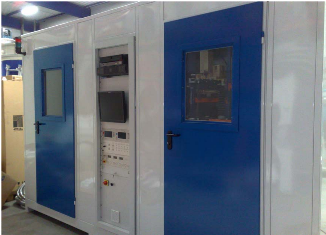
Cage avec deux zones de test – 8 x 2,5 x 2,5m – l'opérateur reste à l'extérieur de la cage
