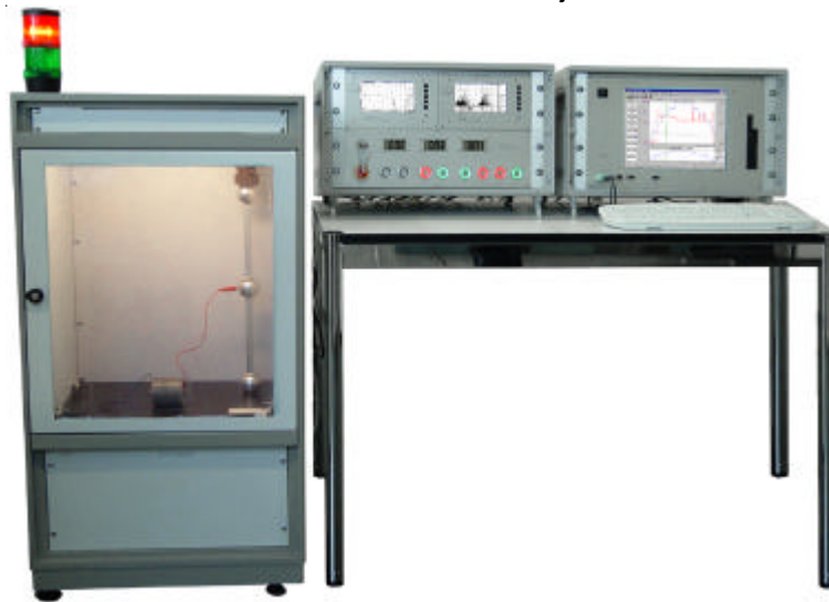
Cage de mesure de DP jusqu'à 10kV avec ICMcompact , STEPcompact , HVcontrol , et PC
