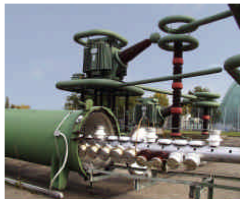
ATTAnalyzer lors d'un test longue durée sur poste blindé (SIEMENS)
