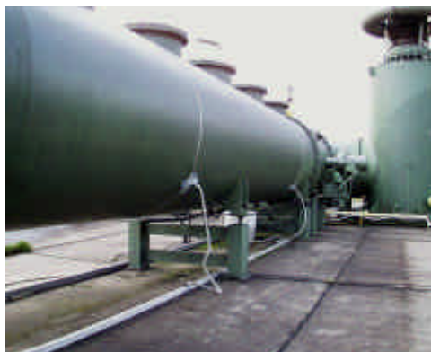
ATTAnalyzer lors d'un test longue durée sur poste blindé (SIEMENS)
