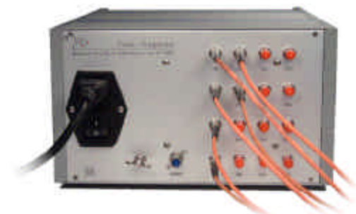
Connections par fibres optiques de l'ATTanalyzer
